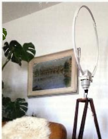
Obr. 34. Anténa MLA-ER na stojanu s rotátorem
