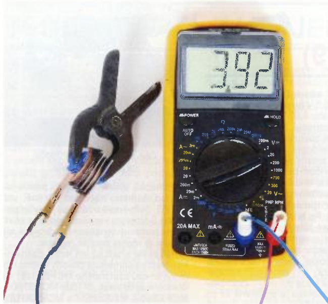
Obr. 7. Čtyřčlávková baterie z mincí a pozinkovaného plechu dodá napětí téměř 4 V
