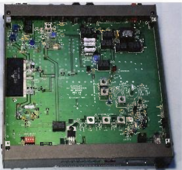
Obr. 6. Detailní pohled do odkrytého transvertoru
