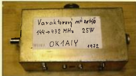
Obr. 11. Varaktorový násobič z pásma 2 m na 70 cm v „konzumním“ provedení, polovina 60. let
