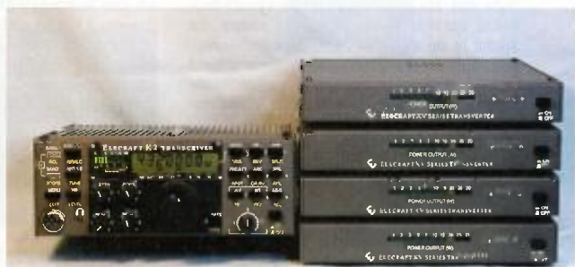
Obr. 5. Transvertory pro jednotlivá VKV pásma lze připojit prakticky k libovolnému transceiveru; v USA mají radioamatéři i pásmo 220 MHz
