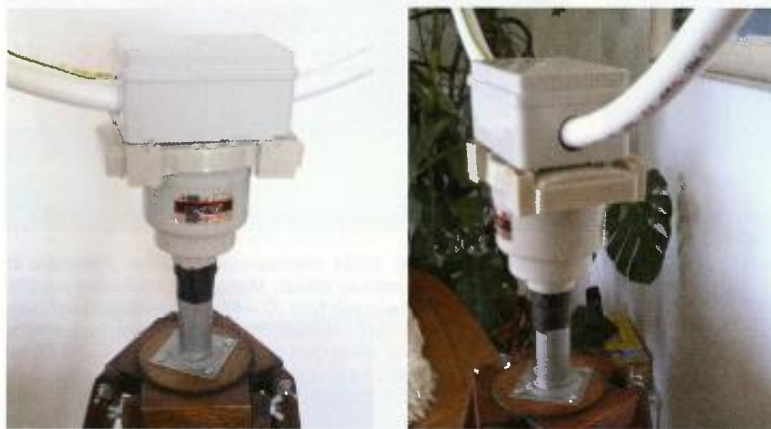
Obr. 35 a 36. Dva detailní pohledy na uchycení antény k rotátoru
