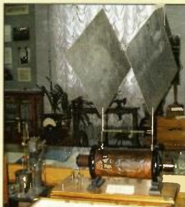
Obr. 4. Replika vysílače (Hertzova generátoru) upraveného A. S. Popovem (Muzeum – laboratoř Elektrotechnické univerzity v Petrohradě)
