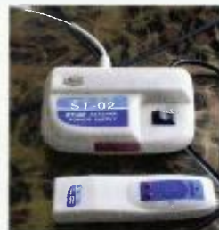
Obr. 37. Napájecí zdroj rotátoru s ovladačem otáčení antény
