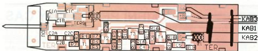
Obr. 4 Rozmístění součástek na deskách TER a TERB testeru re- zonance
